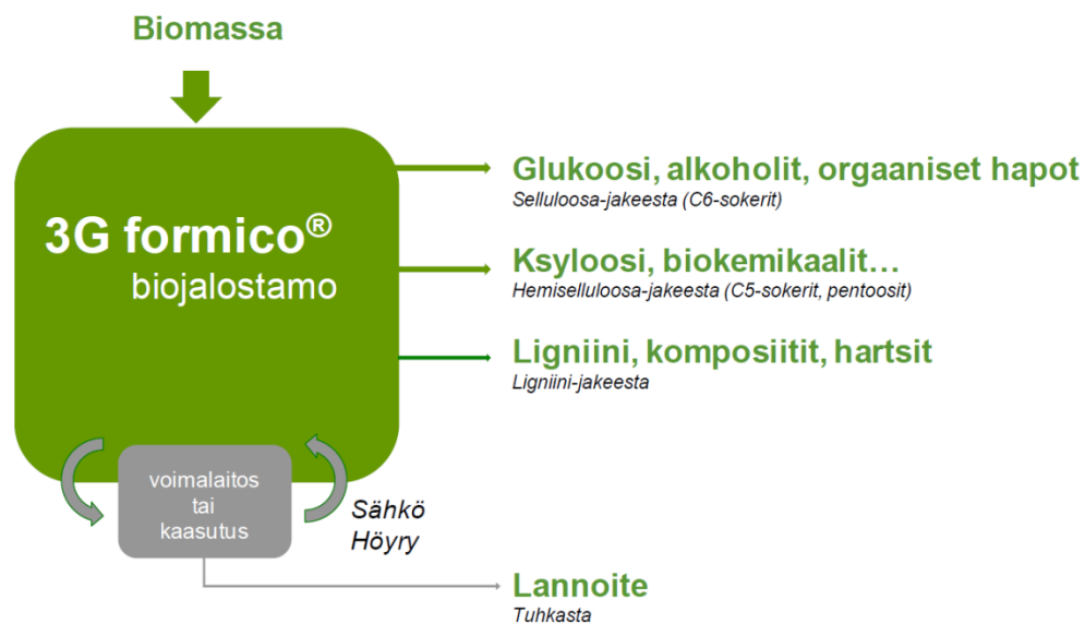
Kuva 2. Kolmannen sukupolven formico®-teknologiaan perustuva biojalostamo
